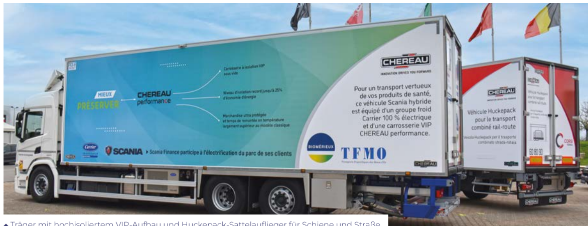
▲ Träger mit hochisoliertem VIP-Aufbau und Huckepack-Sattelaufleger für Schiene und Straße.
